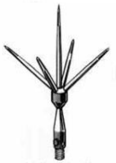
Figura 3 – Extremos de pararrayos en instalaciones terrestres.
