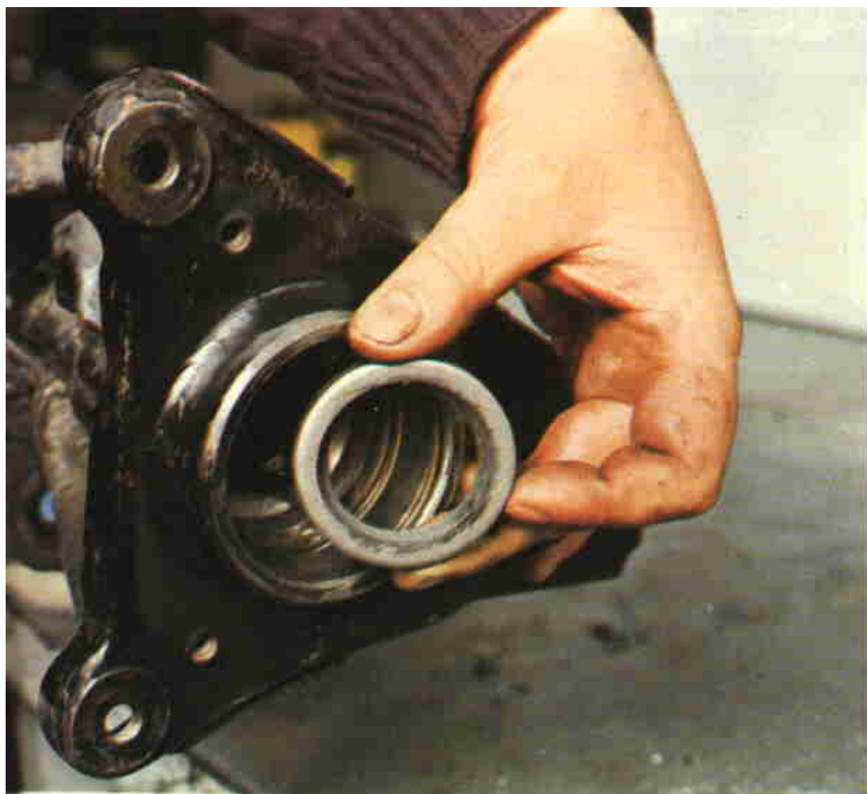
13. Es importante que los retenes de los bujes se hallen en perfecto estado, pues si no fuera así podría haber paso de aceite hacia los conjuntos de frenos.
