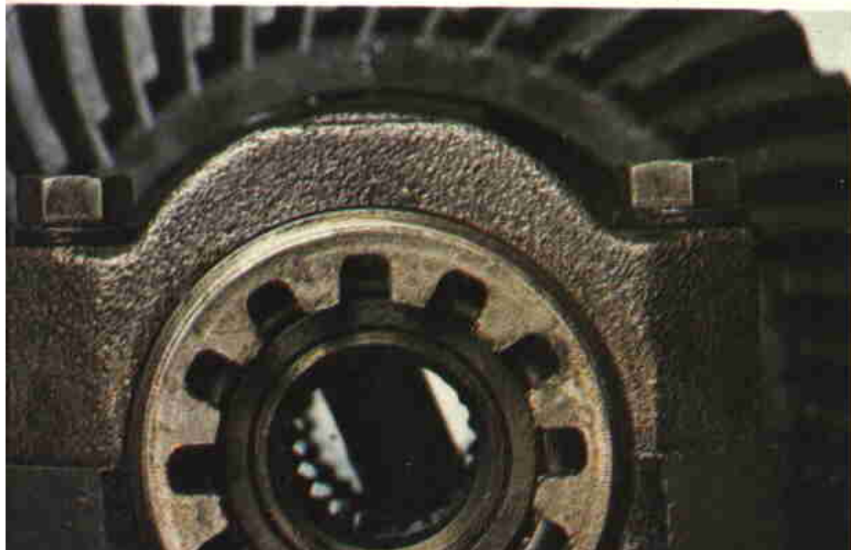
13. Es importante que los retenes de los bujes se hallen en perfecto estado, pues si no fuera así podría haber paso de aceite hacia los conjuntos de frenos.
