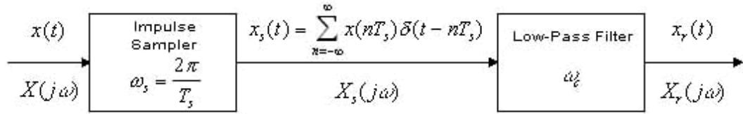
Una señal de tiempo continuo,  $x(t)$  se muestrea a una frecuencia de  $\omega_s \text{ rad/seg}$ , obteniéndose una señal muestreada  $x_s(t)$ . Modelamos  $x_s(t)$  como un tren de impulsos, donde el área del  $n$ -ésimo impulso esta dada por  $x(nT_s)$ . Un filtro pasa-bajos ideal con frecuencia de corte  $\omega_c \text{ rad/seg}$ , es utilizado para obtener la señal reconstruida  $x_r(t)$ .
