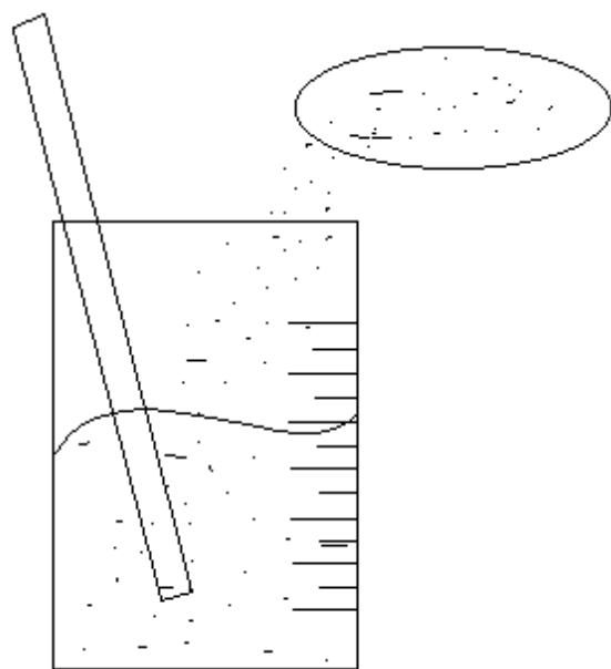
Luego de agregar el NaOH pesado al vaso de precipitados con 20ml, se revolvió con el agitador hasta formar la mezcla homogénea
