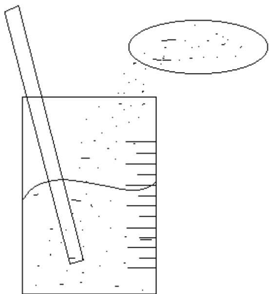
Luego de agregar el NaCl pesado al vaso de precipitados con 40ml, se revolvió con el agitador hasta formar la mezcla homogénea
