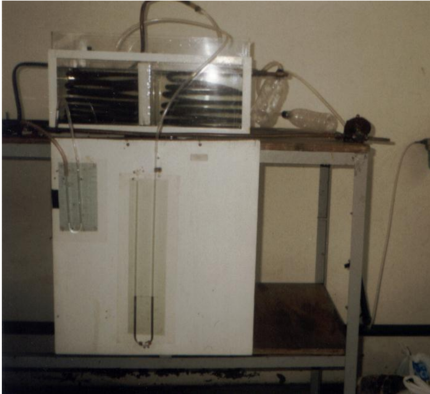
Figura 2. Celda basada en los principios de la Celda de Difusión de Arnold
