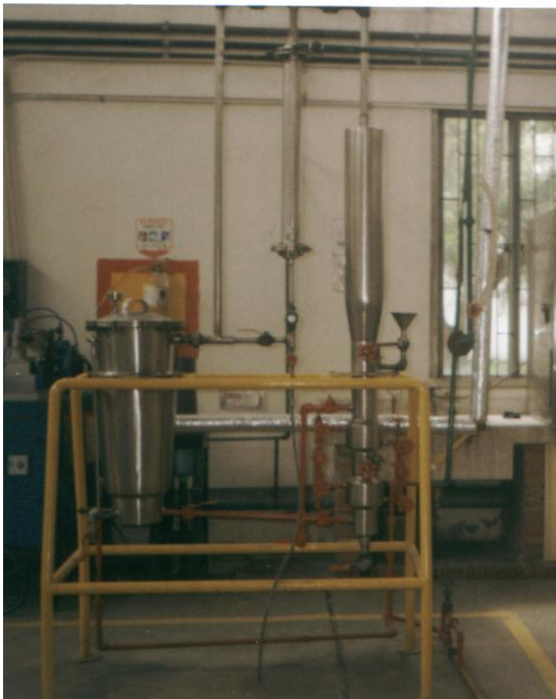
Equipo de extracción sólido-líquido ubicado en el Laboratorio de Ingeniería Química
