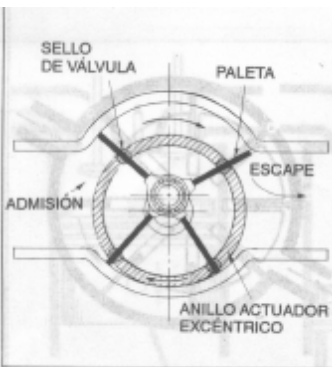
Figura -5—Compresor de paletas excéntricas.
