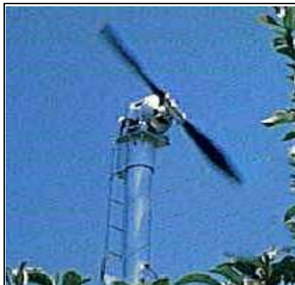
Molino de eje horizontal de dos palas. (para más información sobre los generadores de este tipo véanse los artículos: Generadores eólicos )
