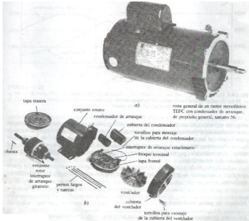
La figura – A Muestra el motor de inducción con condensador de arranque
