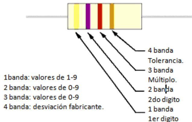
fig. 1: Representación de una resistencia por colores.
