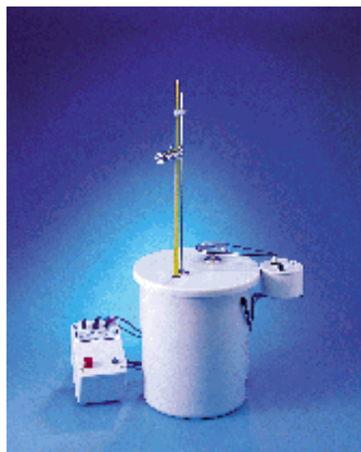
Figura 1. Calorímetro de bomba con unidad de ignición
