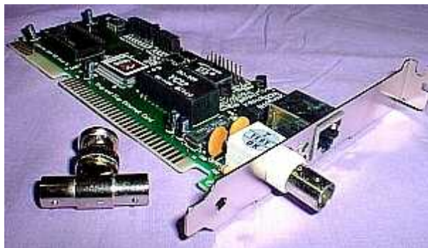
Figura de una tarjeta de Red con un conector BNC y un RJ-45.
