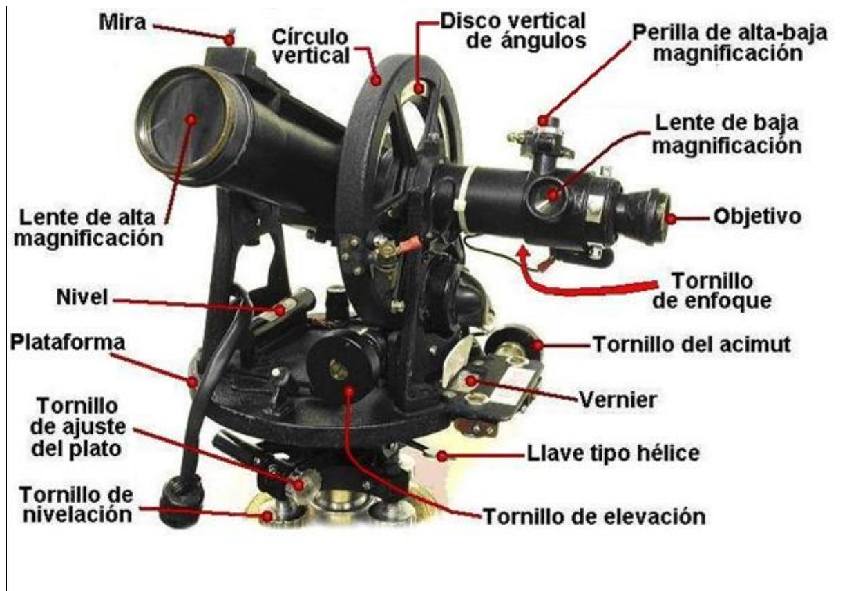
**Figura 2.** Teodolito meteorológico y sus partes.
